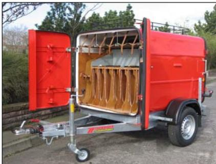
Automatikstützrad mit 250kg Stützlast anstelle des leichten Stützrades 150 kg mit Klemmschelle
