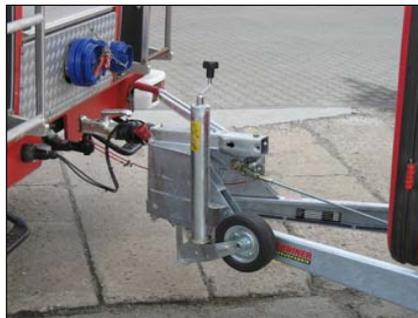
Adapter für Erhöhung Kuppelhöhe, fest verschweißt
