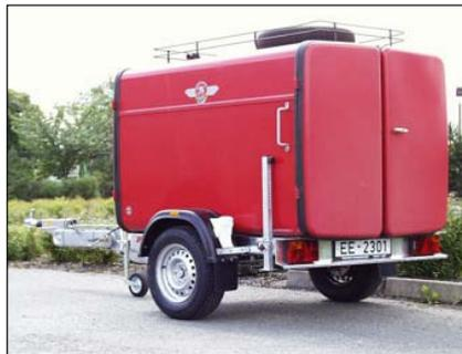
Höhenverstellbare Zugvorrichtung 350-1050 mm, Kugelkupplung und DIN-Zugöse wechselbar mit Verstärkungsprofil für Zugrohrbefestigung
