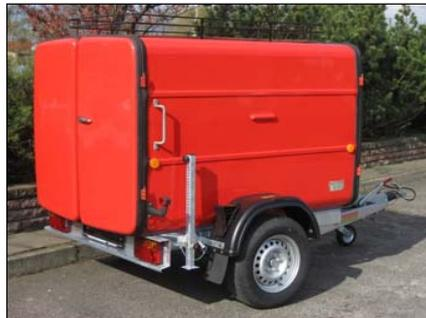
Umrißleuchten hinten rechts und links in Ausführung mit Glühlampe bzw. in LED
